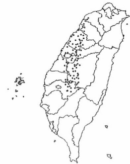
圖7 8月6日莫拉克下午16點至18點統計雨量 R_0 (0.4) 臨界值判定圖
