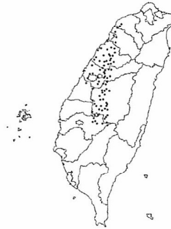
圖8 8月6日莫拉克下午16點至18點統計雨量 R_0 (0.5) 臨界值判定圖
