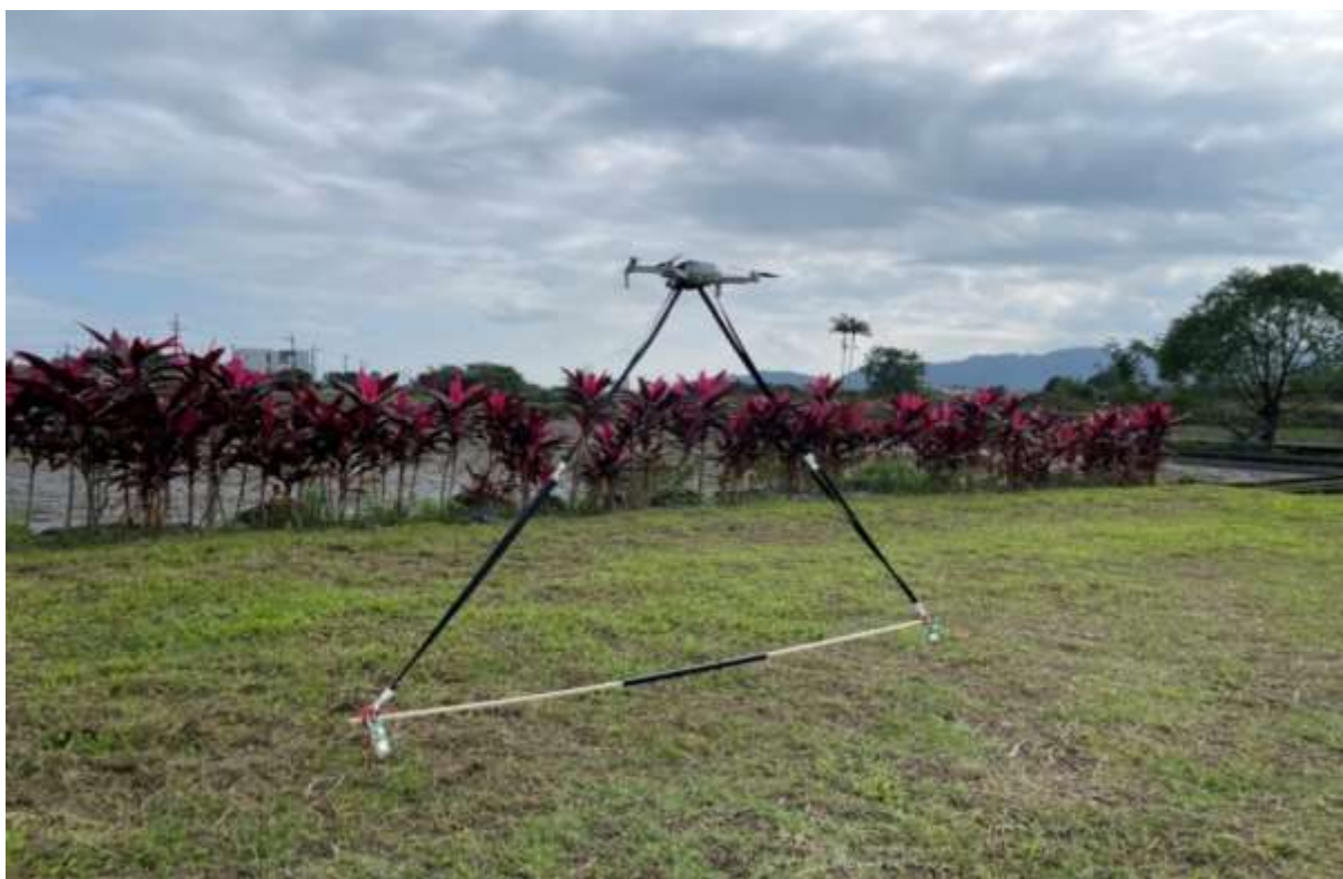
圖23 運用小型無人機加掛微型氣象站蒐集大氣參數(觀測地點:宜蘭縣三星鄉)。
