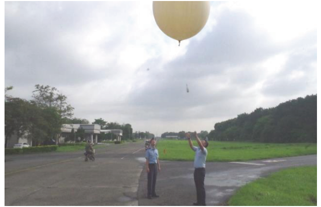
圖4 新式GPS MW41型探空作業執行情況
