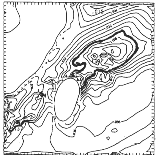
圖11 控制個案第21.3小時，300公尺等高面熱通量。粗實線所包含區域通量大於 0.1 \text{ m}^{\circ}\text{K}/\text{sec} 。等值線間距為 0.009 \text{ m}^{\circ}\text{K}/\text{sec} 。
