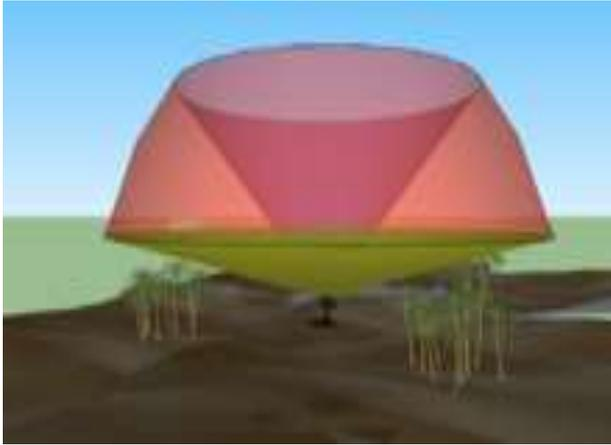
圖3 不同高度雷達掃描體積示意圖
