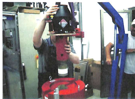
圖2.2 2008年德籍技師安裝 Meteor 1600C型調速管
