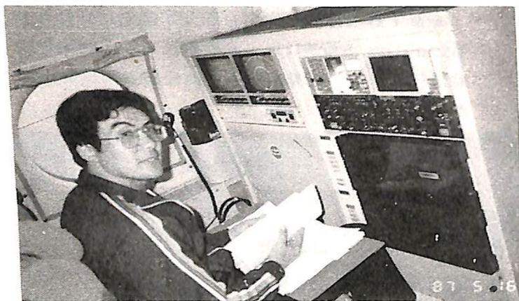
圖 6：飛機內雲物理操作台，磁帶錄音座有双套，操作者為中央氣象局張修武先生。
