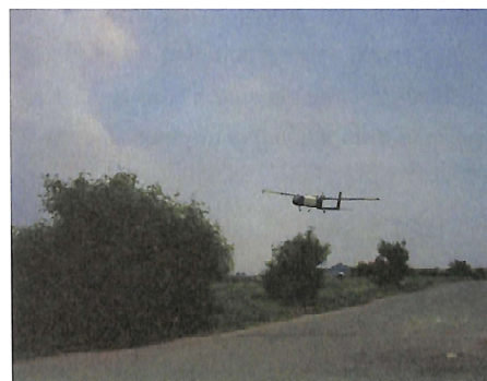
圖3 無人飛機在大林蒲執行空氣品質監測任務
