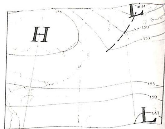
圖二(b)：850hpa之高空圖，時間與(a)圖相同，台灣地區位於太平洋高壓南緣的東風帶，北邊槽線雖向南伸展但僅及北緯30°，同時水汽含量不足，低層噴流不明顯，並無充分理由有造成雷雨之機會。
