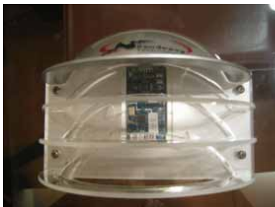
圖 3 自製通風遮罩,內置 Tmote sky 無線感測網路節點。
