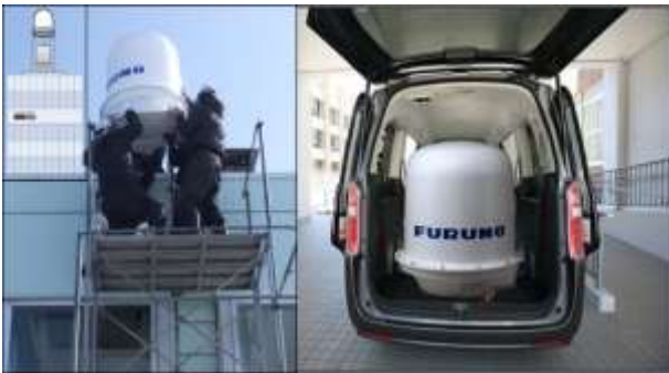
圖5 原廠以3員人力示範高移動性雙偏極化X-band降雨雷達拆裝搬運過程。
