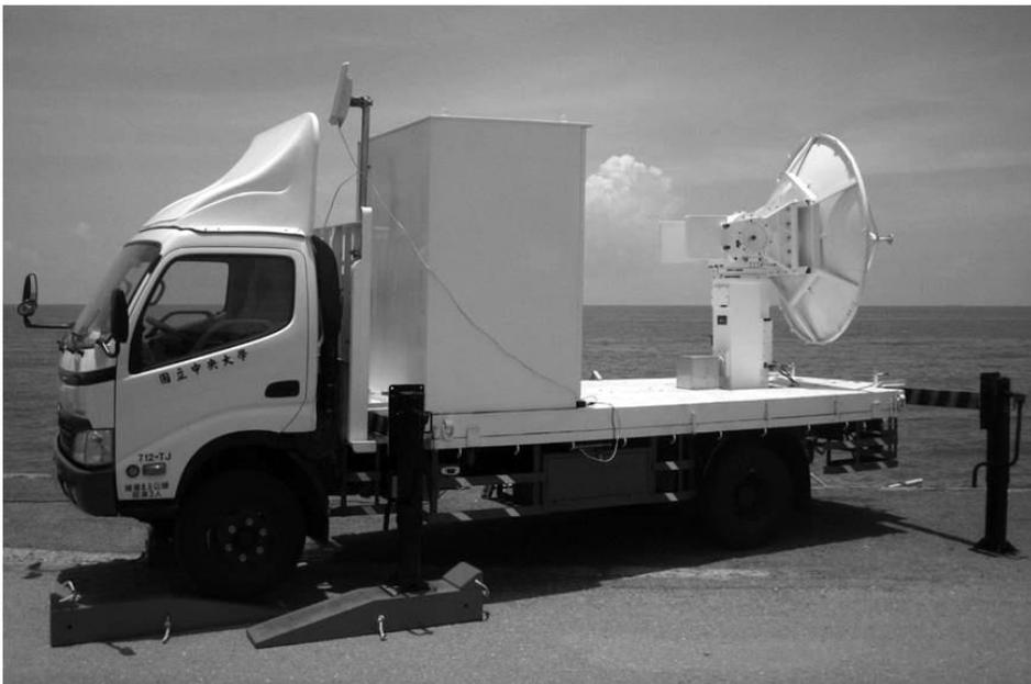
圖 2 TEAM-R (Taiwan Experimental Atmospheric Mobile-Radar)。
