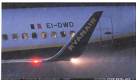
圖1-9 國外飛機設計廠商會在機翼尾端加上小翼(Winglet)，透過外型的流力設計，來減少受限渦流的影響與干擾
