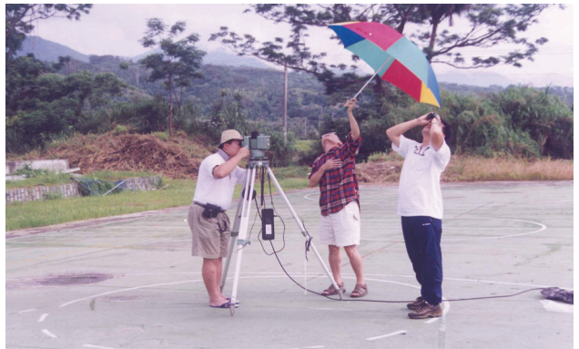
圖六 國防大學中正理工學院氣象組師生於 2001 年 5~6 月參與綠島中尺度實驗的實況，相片顯示當年 5 月 19 日正在施放探空氣球和操作電子經緯儀，量測臺東縣鹿野地區高空風變化。(何台華提供)
