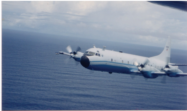
圖五 中正理工學院何台華教授參與國際大氣海洋偶合反應野外觀測實驗(TOGA-COARE)的實況，圖示 1993.01.13 美國國家大氣研究中心 NCAR 所屬的 Electra 飛機正進行熱帶海洋上空 100 英尺高度之邊界層氣象量測任務。(何台華提供)
