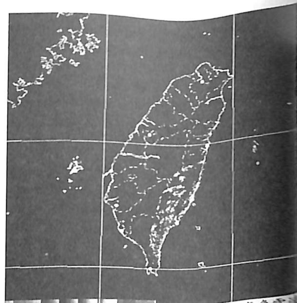
圖三(a): 84年6月28日0355Z本軍綠島氣象雷達觀得之降水回波圖，圖中各地均無明顯回波，表示雷雨胞尚未生成。
