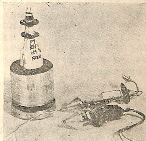
圖六：亞爾卡斯火箭所帶無線電發射機
