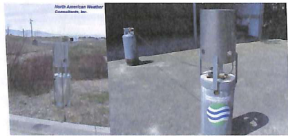
圖二 北美天氣改造公司 (NAWC) 設計的地面造雨設備 (左)，水利署目前使用之地面造雨設備 (右)。
