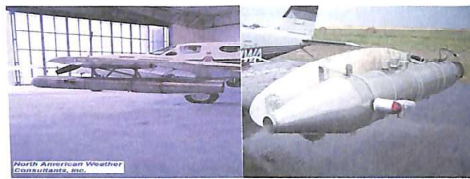
圖五 北美天氣改造公司 (NAWC) 設計在機翼下 (左) 或翼梢 (中) 固定架設燃燒碘化銀溶液器。
