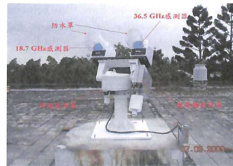
圖九 地基雙偏極化微波輻射計外觀及各單元介紹 (摘自葉等, 2011)
