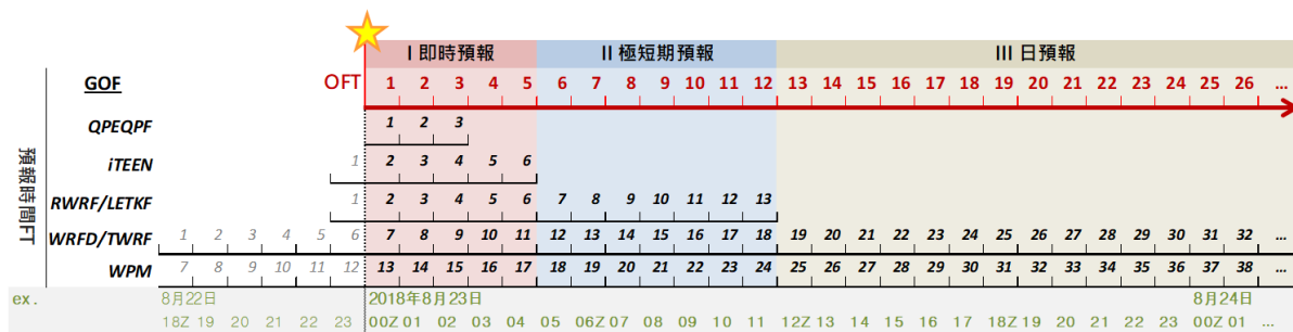
圖 2：實際作業時（星號，例如 2018 年 8 月 23 日 00Z）進行對未來 72 小時進行預報（OFT，紅字）區分為三個預報時段，對應下列各 GOF 的預報時間（FT，斜體數字），其中到位延遲時間之前的預報在作業時無法使用，以灰色斜體數字表示（例如 iTEEN 到位延遲時間為 1 小時），作業時可使用的預報時間以黑灰斜體數字表示（例如 iTEEN 可使用的預報為 FT=2-6 小時，對應 OFT=1-5 小時），詳細說明請見內文。
