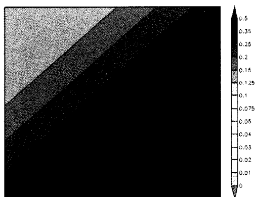
圖 5 無台灣地形個案模擬 1 小時後之最底層可感熱通量（色階，單位為 Kms^{-1} ）。
