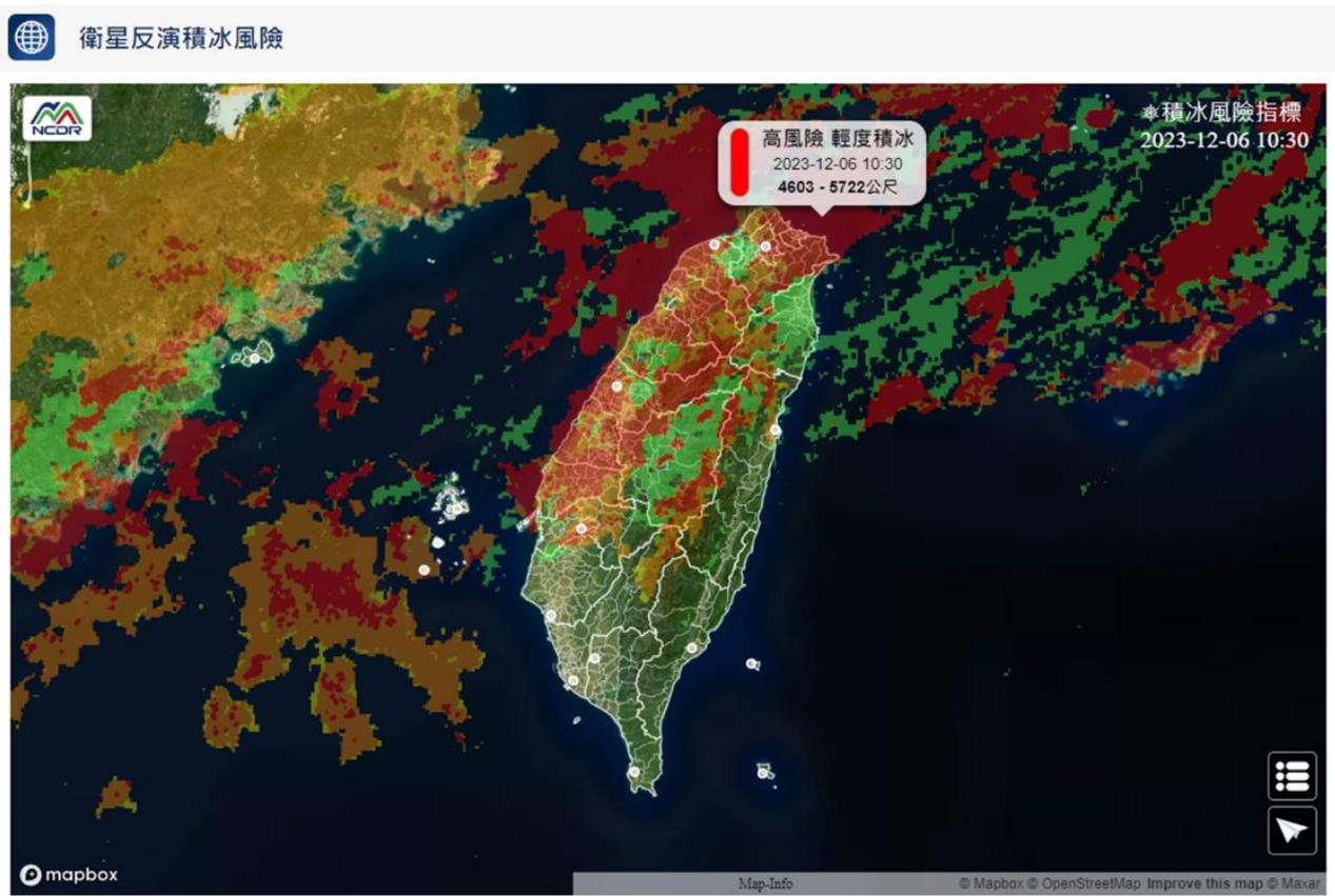
圖 5 WATCH 系統以 MapBOX 展示飛航積冰風險一例。
