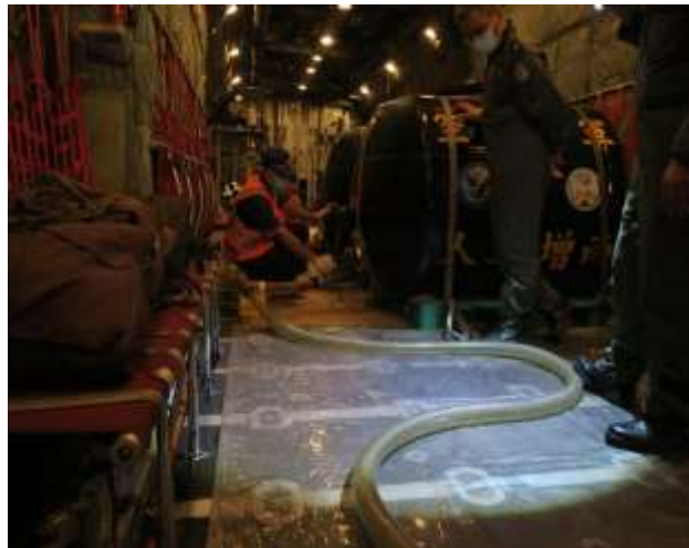
圖6 連接蓄水桶及排水管
